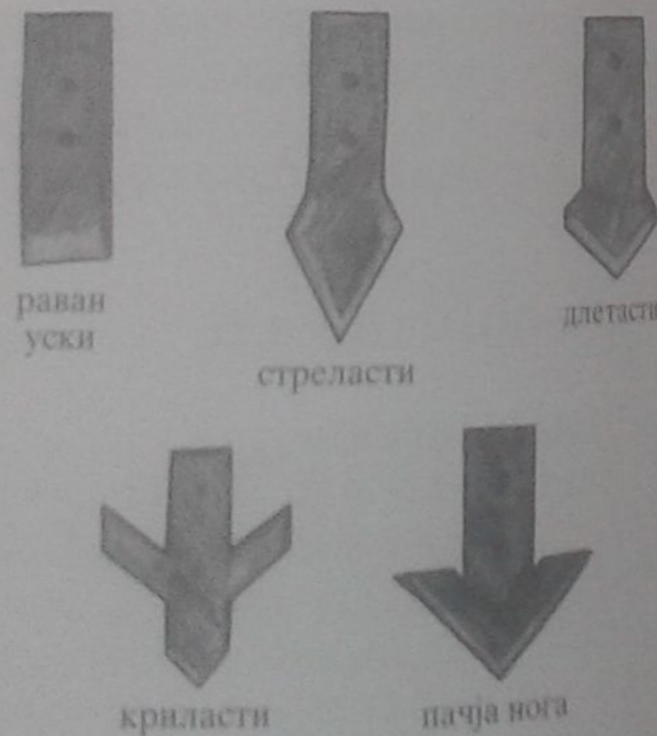
Сл. 15. Облици радних органа – ножева за култивирање, разривање и подривање
